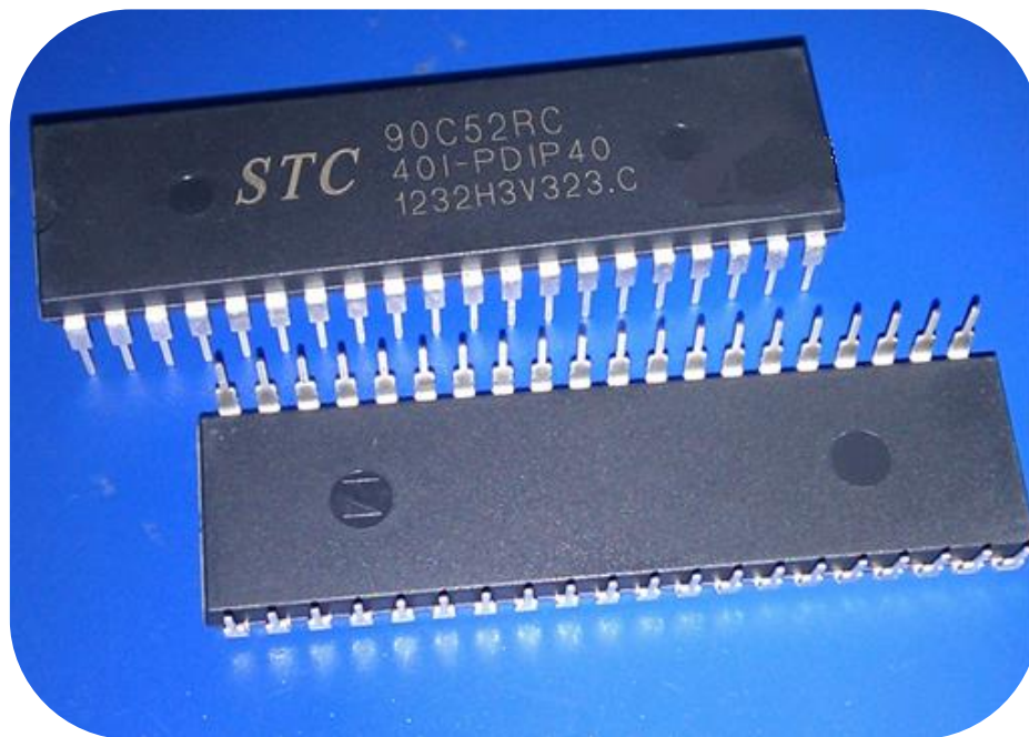
图 1- 6 STC90C52RC 单片机实物图
